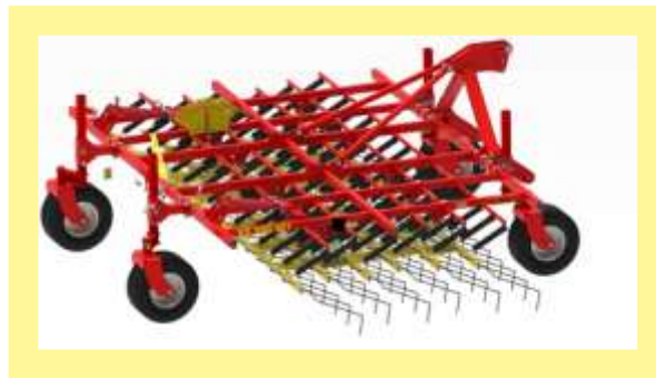
Figura 11: Atașare frontală cu 4 roți de palpare
