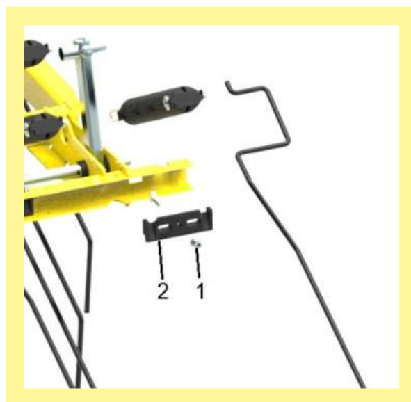
Rysunek 15: 1 = nakrętka, 2 = pakiet z tworzywa sztucznego
