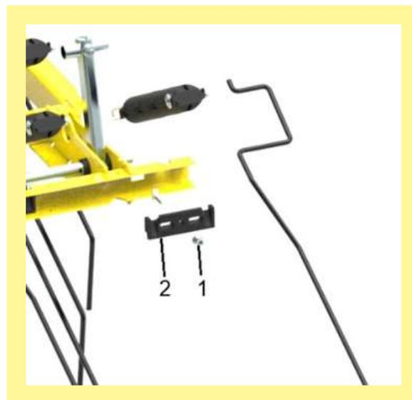
Figure 15 : 1 = écrou, 2 = bloc en matière synthétique
