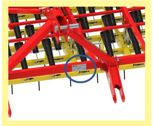
Figure 1 : Emplacement de la plaque signalétique
