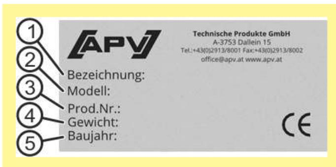
Figure 2 : Structure de la plaque signalétique
