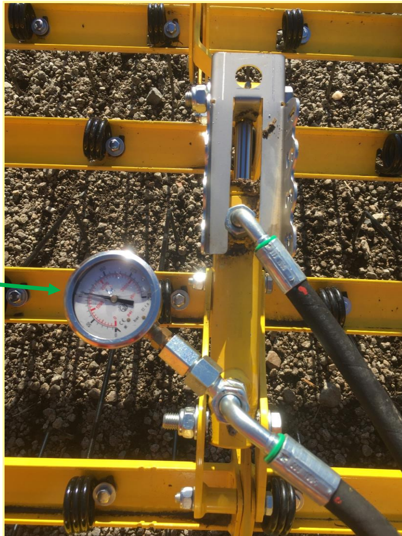
Abbildung 5: Einstellen des DBVs mittels Manometer am Hydraulikzylinder der hydraulischen Zinkenverstellung
